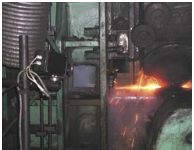
Термоскоп-800-2С. Сварка трубы
