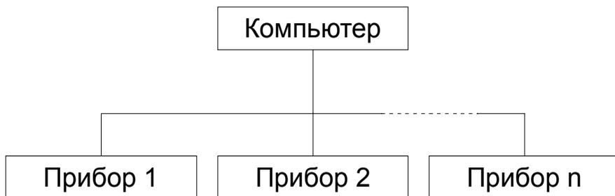
Рис.19. Принцип «master-slave».
