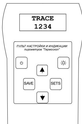
*Рис. 7. Портативный пульт настройки и индикации*
