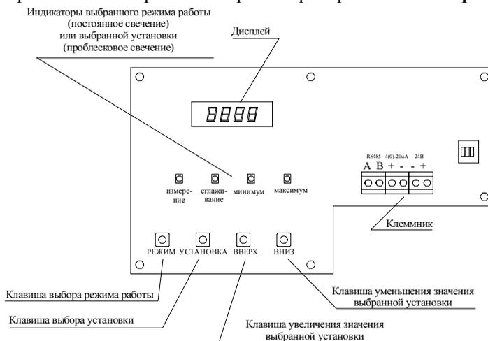
Рис. 20. Органы настройки прибора
