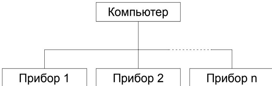
Рис.15. Принцип «master-slave».
